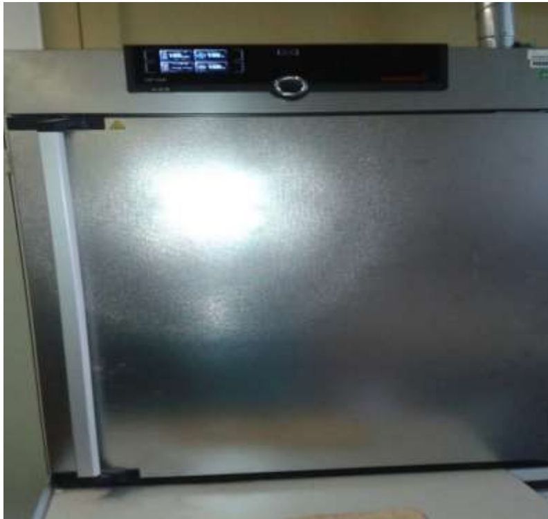
Figure 1: Oven Memmert UF 260 (505 °C)
